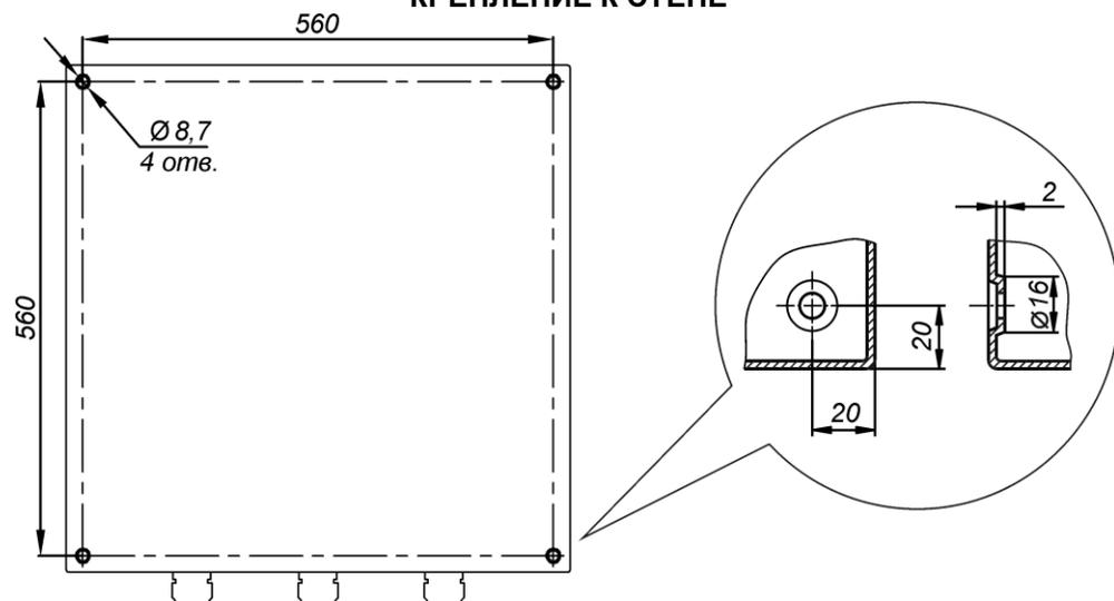
Отверстия для крепления к стене предусмотрены на задней стенке термощкафа.
