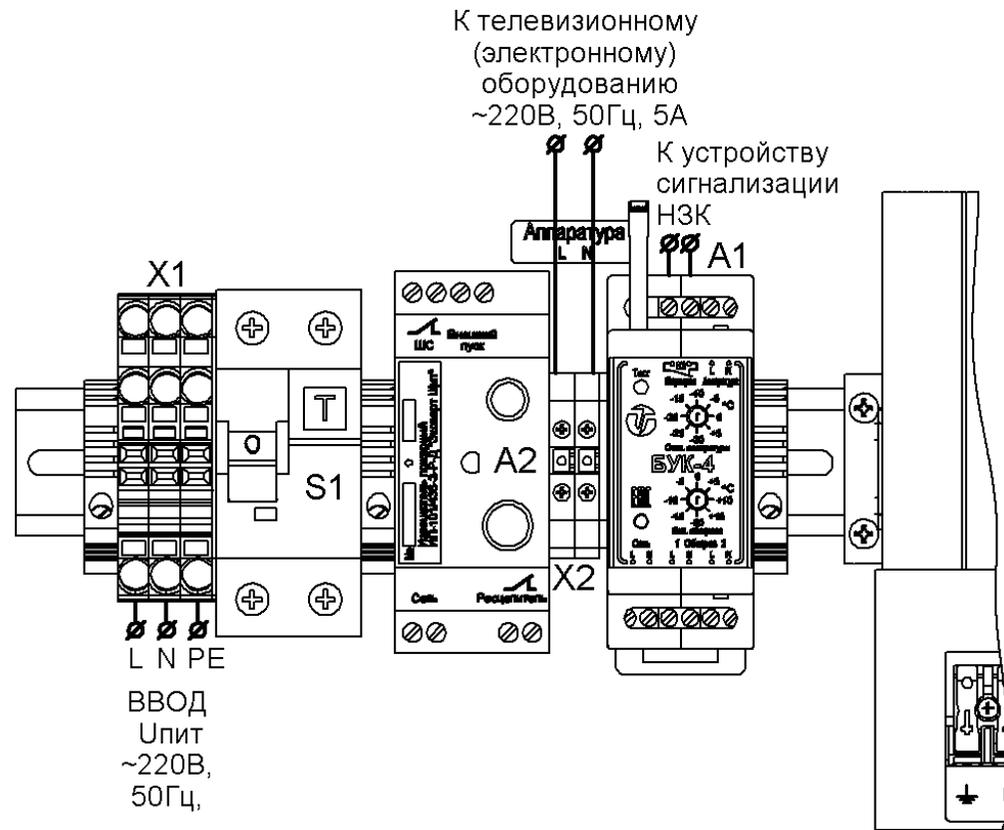
Рис.2 Подключение термощафа
