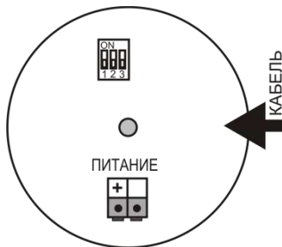
Рис.4 - Расположение клеммников и микропереключателей в коммутационном отсеке оповещателей «Плазма»Ex-CP и «Плазма»Ex-P
