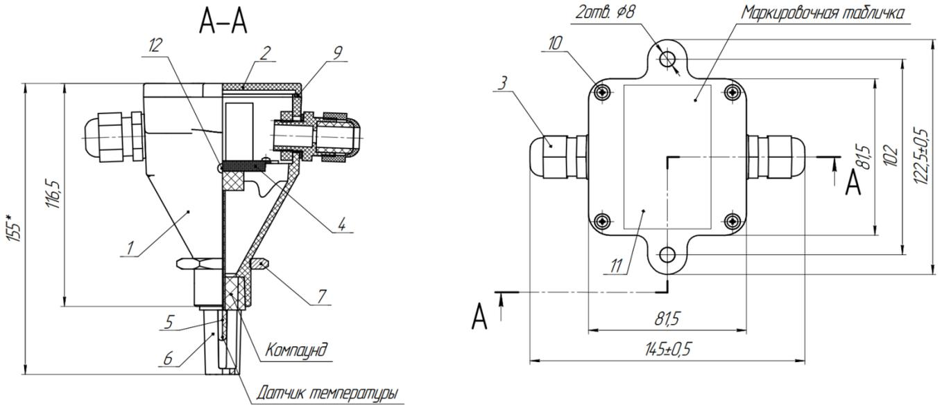
1 – корпус; 2 – крышка; 3 – кабельный ввод; 4 – печатная плата; 5 – терморезистор; 6 – защитный колпачок; 7 – контргайка; 9 – уплотнитель; 10 – винт; 11 – маркировочная табличка, 12 – индикатор.
