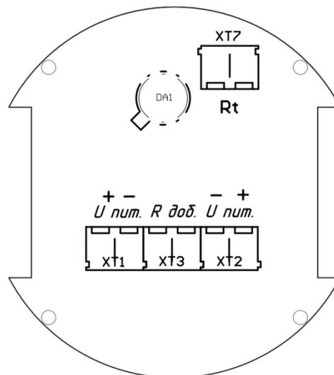
**Рис. 2. Расположение монтажных клемм извещателя в безадресном исполнении.**
