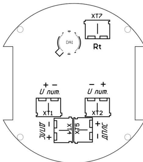
**Рис. 4. Расположение монтажных клемм извещателя в исполнении с адресной меткой.**
