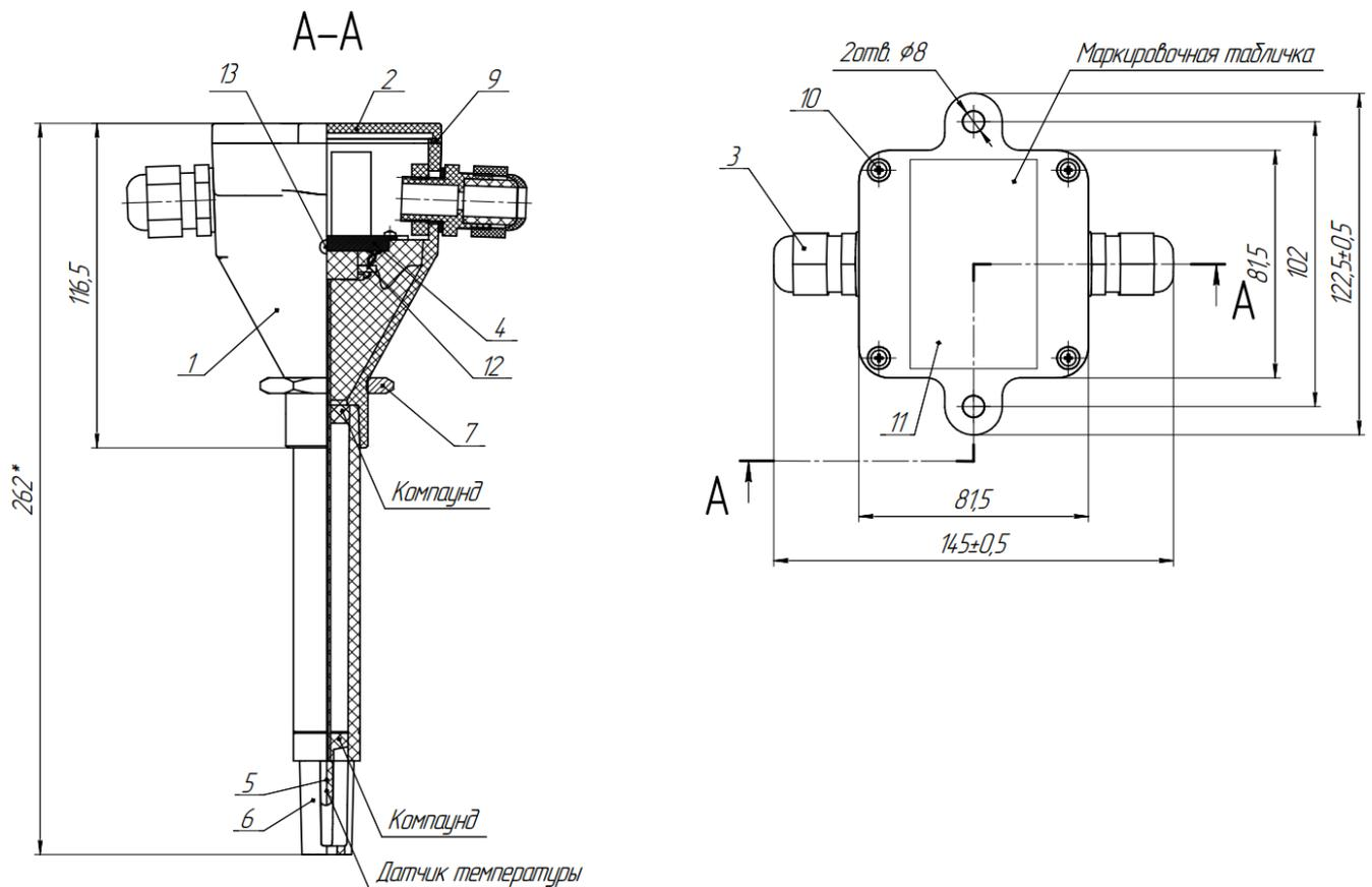
1 – корпус; 2 – крышка; 3 – кабельный ввод; 4 – печатная плата; 5 – терморезистор; 6 – защитный колпачок; 7 – контргайка; 9 – уплотнитель; 10 – винт; 11 – маркировочная табличка, 12 – адресная метка, 13 – индикатор.
