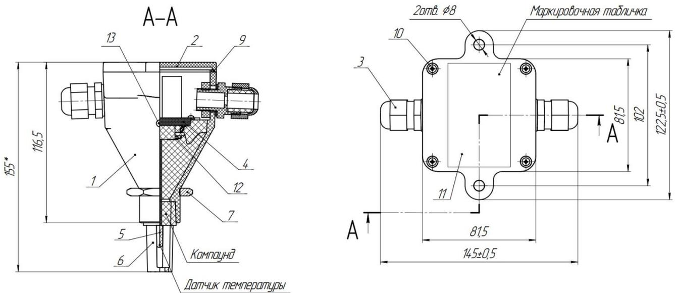
1 – корпус; 2 – крышка; 3 – кабельный ввод; 4 – печатная плата; 5 – терморезистор; 6 – защитный колпачок; 7 – контргайка; 9 – уплотнитель; 10 – винт; 11 – маркировочная табличка, 12 – адресная метка, 13 – индикатор.
