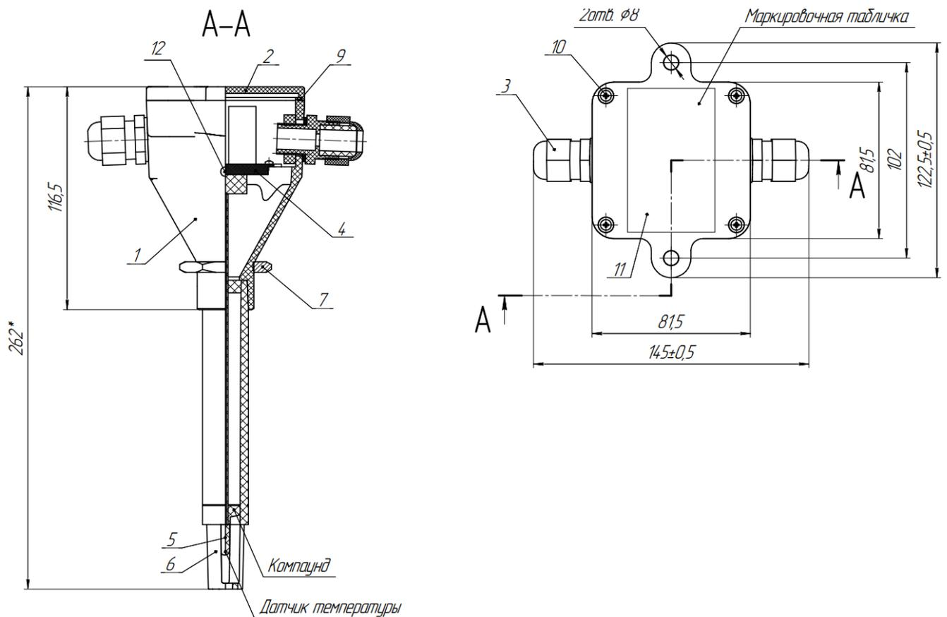
1 – корпус; 2 – крышка; 3 – кабельный ввод; 4 – печатная плата; 5 – терморезистор; 6 – защитный колпачок; 7 – контргайка; 9 – уплотнитель; 10 – винт; 11 – маркировочная табличка, 12 – индикатор.
