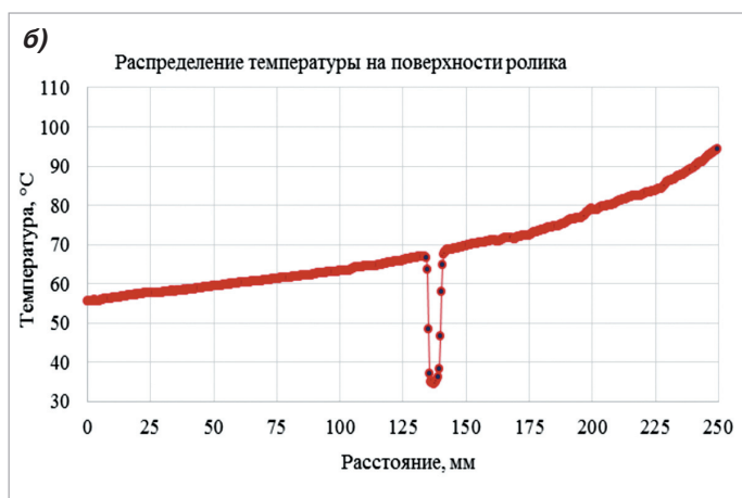
Рисунок 8. Перегрев 200°C правым подшипником:
