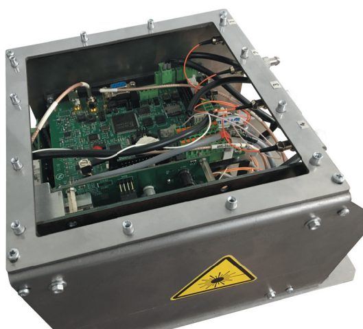
Рисунок 3. Блок оптоволоконных датчиков системы ТОРЕКС (в открытом виде).
