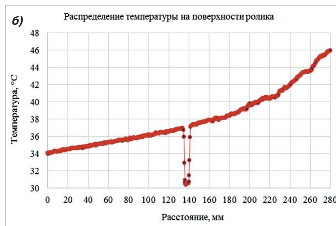
Рисунок 7. Перегрев 50°C правым подшипником:
