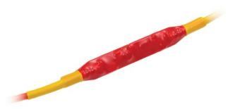
Извещатели пожарные ProCab многоточечные газовые и комбинированные обнаруживают пожар по появлению угарного газа (СО) в диапазоне 15-100pm. Измерения проводятся цифровыми датчиками электрохимическими сенсорами, обладающими высокой селективностью. В цифровом датчике газа применён контроль сенсора по старению и повреждению, контроль исправности датчика. Газовые датчики, по сравнению с дымовыми извещателями, менее капризны к месту установки, более чувствительны к продуктам тления.
